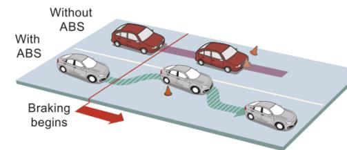
*Anti Lock Braking System* mencegah penguncian roda saat pengereman mendadak. *Electronic Brake Force Distribution* berfungsi mendistribusikan daya pengereman sesuai beban kendaraan serta dibantu dengan *Brake Assist* untuk pengereman lebih efektif.
